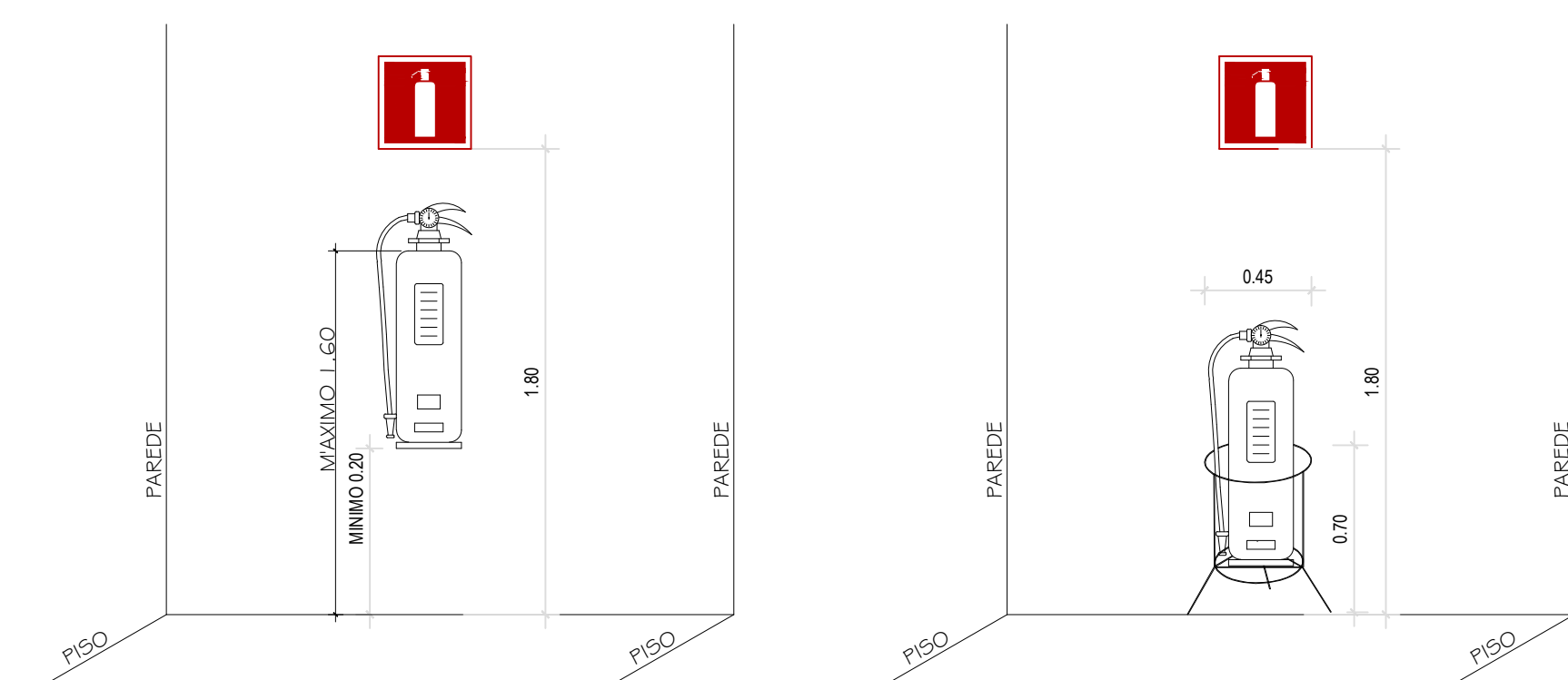
DETALHE - EXTINTOR DE INCÊNDIO S/ESCALA
