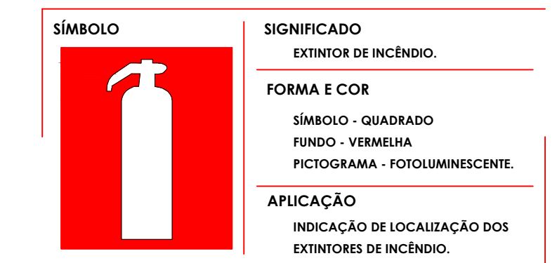
DETALHE - SINALIZAÇÃO EXTINTOR S/ESCALA
